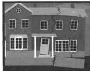
E iniezioni di resine espansive ad alta resistenza con eventuale sollevamento di edifici e pavimenti
